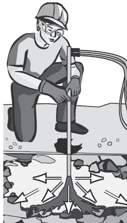
Figura 1: Estabilización de suelos
